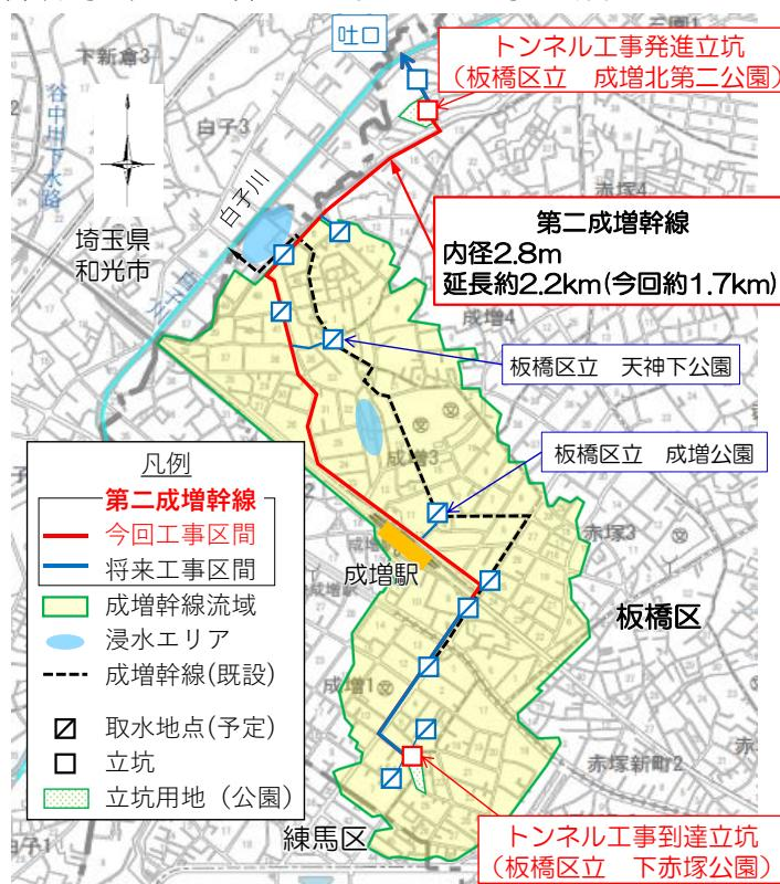
「第二成増幹線工事」は、上図の赤色着色した部分のトンネル工事及び立坑工事を行います。引き続く工事において、青色着色した部分のトンネル工事を行います。
