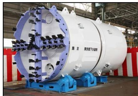
「成増北第二公園」に築造する発進立坑から「下赤塚公園」に築造する到達立坑に向けて、約 12~34m 地下をシールドマシンにより掘り進めます。
